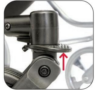
Med spärren i nerfällt läge är framhjulen svängbara, när spärren förs upp låser den hjulen i fast läge.
