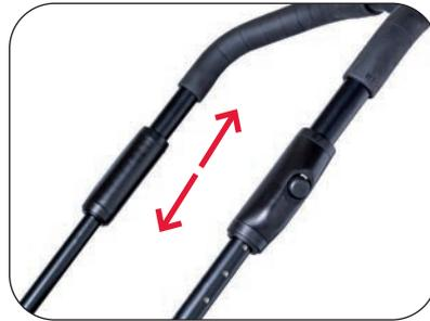
Ställ höjden på skjutstången genom att trycka in knapparna på höjdreqlagen på skjutstångens båda sidor. Höj / sänk skjutstången till önskat läge, släpp knapparna och skjutstången låser i det nya läget.
