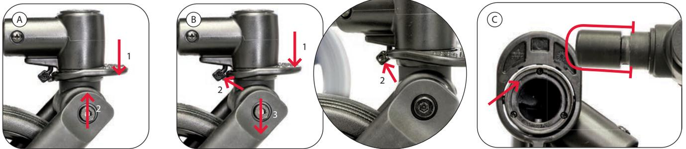
(A) 1. Tryck ner swivelhjulets låsöppning. 2. Tryck hjulpaketet på hjulfästet tills det fastnar med ett klick. Kontrollera att det sitter fast genom att försiktigt dra i hjulet.
