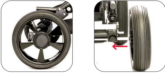
Tag bort axelskydden och spara dem för framtida bruk (skydd vid transport utan hjul). Se till att parkeringsbromsen är i uppfällt läge. För på hjulet på axeln så långt som möjligt med låsknappen intryckt. Släpp knappen och kontrollera att hjulet sitter fast.
